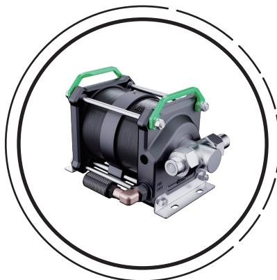
瀚孚工业HFLG系列气动液体泵是以压缩空气作为驱动源，将液体介质增压至需求压力。可针对油、水以及其他各类特殊液体介质，最高输出压力可达600MPa，在诸多应用场景下发挥着关键作用，特别是对安全要求极高的防爆领域。
