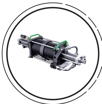
瀚孚工业HFG系列气动气体增压器设计用于气体无油增压，在驱动端和增压端之间采用了动态密封隔绝两个腔体，并设置有气体排出口，从而避免介质气体受到污染。瀚孚工业气动气体增压器广泛应用于各类工业气体（如氮气、氢气、氩气、氦气、甲烷等）的无油压缩，工作压力可达180MPa。
