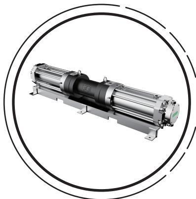
瀚孚工业HFHG1系列液驱气体增压器是以低压液压油作为驱动源,将介质气体增压至需求压力。液驱气体增压器标准设计最高工作压力为17,000psi,针对更高工作压力,可提供特殊设计。液驱气体增压器高效的服务于气体超高压大流量工况。
