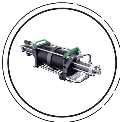
瀚孚工业HFG系列气动气体增压器以压缩空气作为动力源,将介质气体增压到需求压力,广泛应用于各类工业气体(如氮气、氢气、氩气、氦气、甲烷等)的无油压缩,工作压力可达22,000psi。
